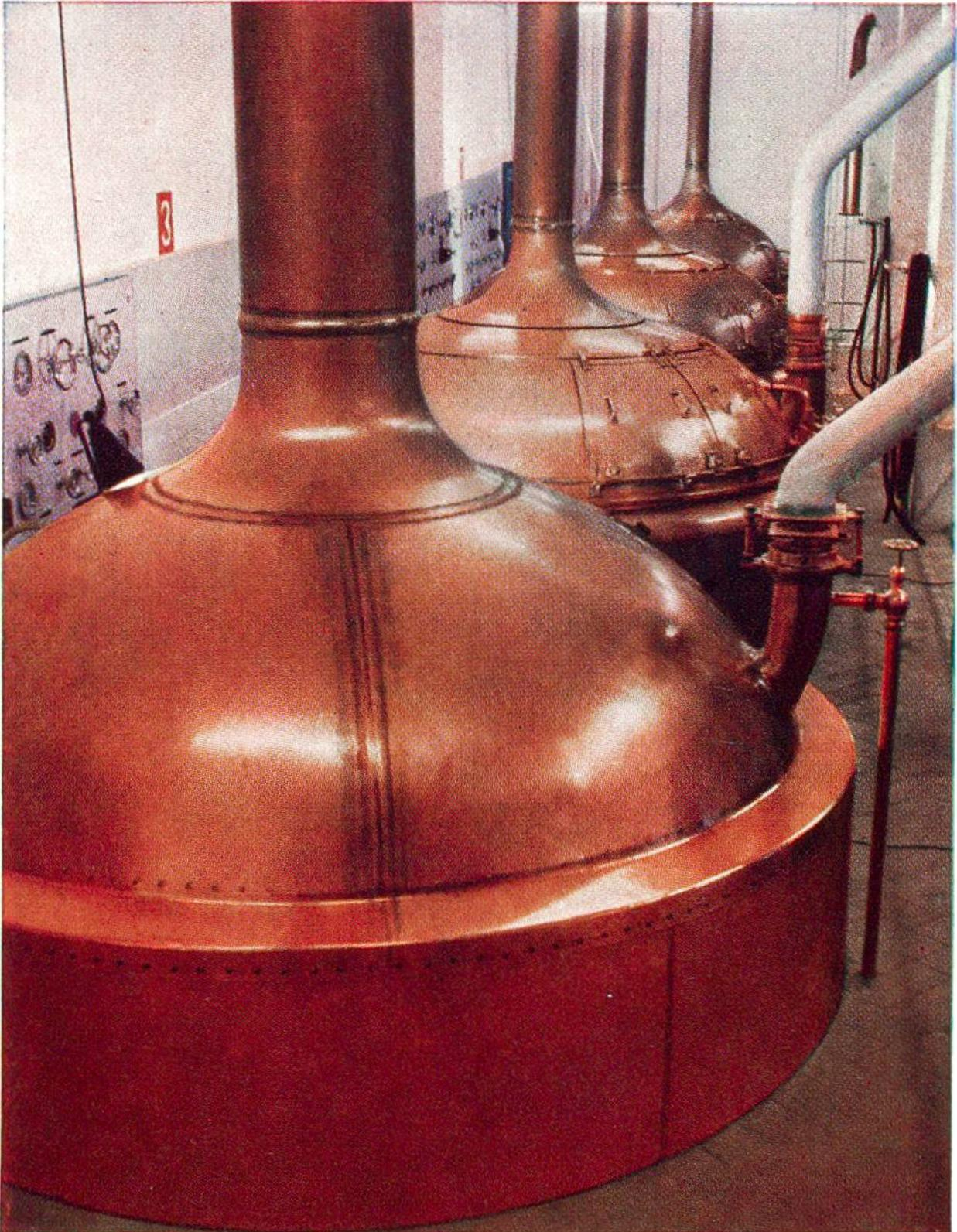
Maischbottiche für die Gewinnung der Malzwürze bei der Herstellung von Malzextrakt.
