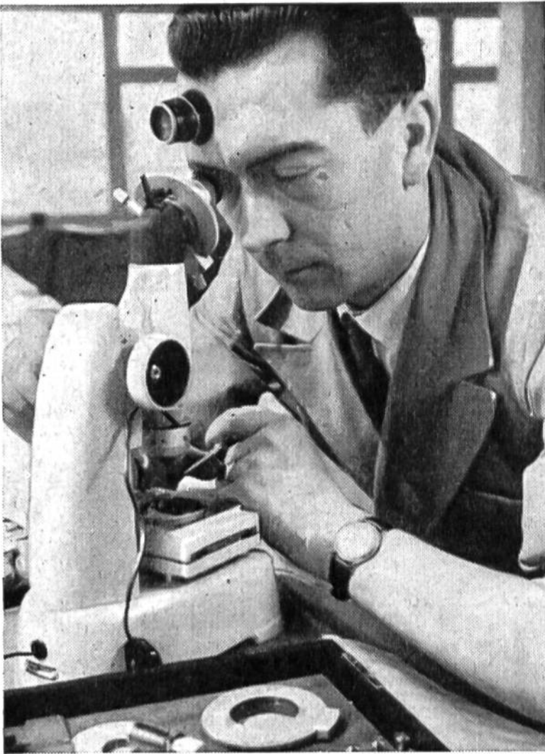
Einzelne Teile der Uhr müssen auf einen Tausendstel-Millimeter genau gearbeitet werden.
