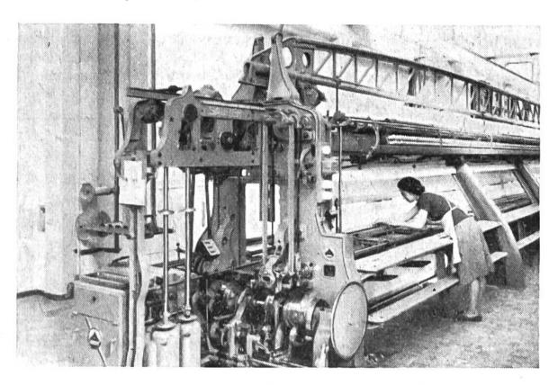
Automatische Schifflistickmaschine. Die während des Stickens abgerissenen Fäden werden von geschickten Arbeiterinnen ohne Arbeitsunterbruch der Maschine wieder eingefädelt.
