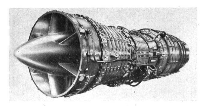
1956: Düsentriebwerk Bristol Olympus mit einer Leistung von ca. 5000 kg Schub entsprechend 18500 PS bei 1000 km/h. Gewicht 1600 kg. Leistungsgewicht 0,32 kg/kg Schub oder 0,08 kg/PS. Eines der stärksten Triebwerke der Welt, mit dem auch der Höhenweltrekord von über 20000 m erreicht wurde (zweimotorige Olympus Canberra).
