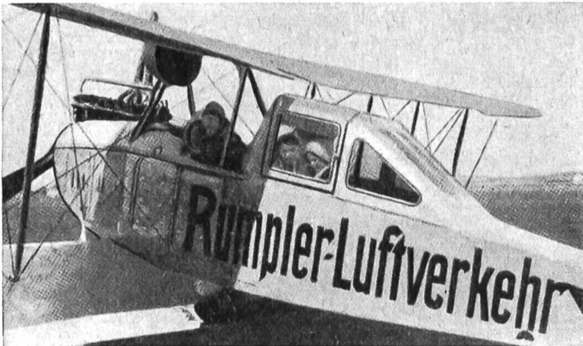
1920: «Rumpler-Luftlimousine», eines der ersten Verkehrsflugzeuge. 2 Passagierplätze in «Luxuskabine mit elektrischer Birne und stoffdrapierten Wänden, Vorhang und Blumenvase». Spannweite 12 m, Fluggewicht 1300 kg. Motorleistung 160 PS. Reisegeschwindigkeit ca. 130 km/h. Reichweite max. 750 km.
