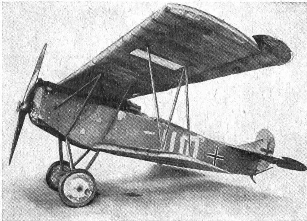
1917: Fokker D-7. Jagdflugzeug aus dem Ersten Weltkrieg. Doppeldecker von 8,9 m Spannweite. 1 Mercedes-Motor mit Flüssigkeitskühlung von 160 PS. Höchstgeschwindigkeit ca. 170 km/h. Bewaffnung: 2 durch den Luftschraubenkreisfeuernde Maschinengewehre.
