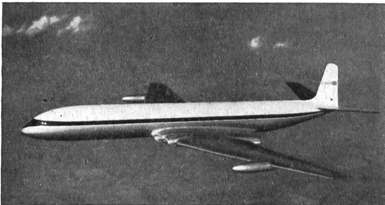
1956: Comet IV, 4motoriges Düsenverkehrsflugzeug für 60–76 Passagiere in Druckkabine. Spannweite 35 m. Fluggewicht 70000 kg. Reisegeschwindigkeit 800 km/h. Motorleistung 18144 kg Schub, entsprechend ca. 53000 PS bei 800 km/h. Reichweite 4800 km.
