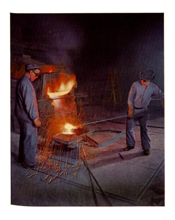
Entnahme einer Stahlprobe am Elektro-Ofen.
