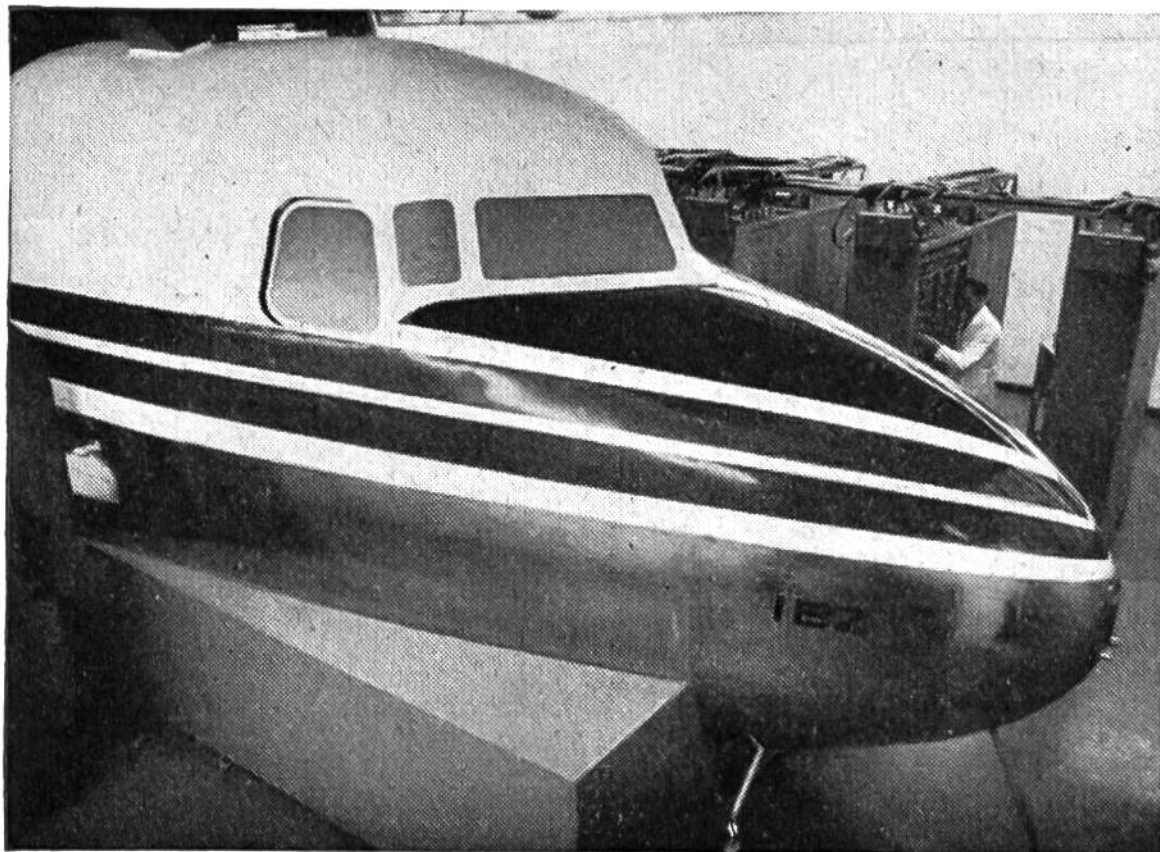
Der Flight Simulator von aussen. In der Bildmitte die genaue Nachbildung der Nase eines DC-6B, im Hintergrund die vier Elektronenkasten, von denen jeder einen Motor und seine Funktionen darstellt.
