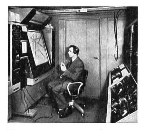
Ein Panthograph zeichnet die von den Pilotenschülern Flight-Simulator «geflogene» Route auf; sie wird von einem Instruktor überwacht, der mit den Piloten in Funkverbindung steht und wie der Beamte im Kontrollturm Flughafens die nötigen Start- und Landeanweisungen gibt. Dabei können die technischen Gegebenheiten jedes beliebigen Flughafens «simuliert» werden.
