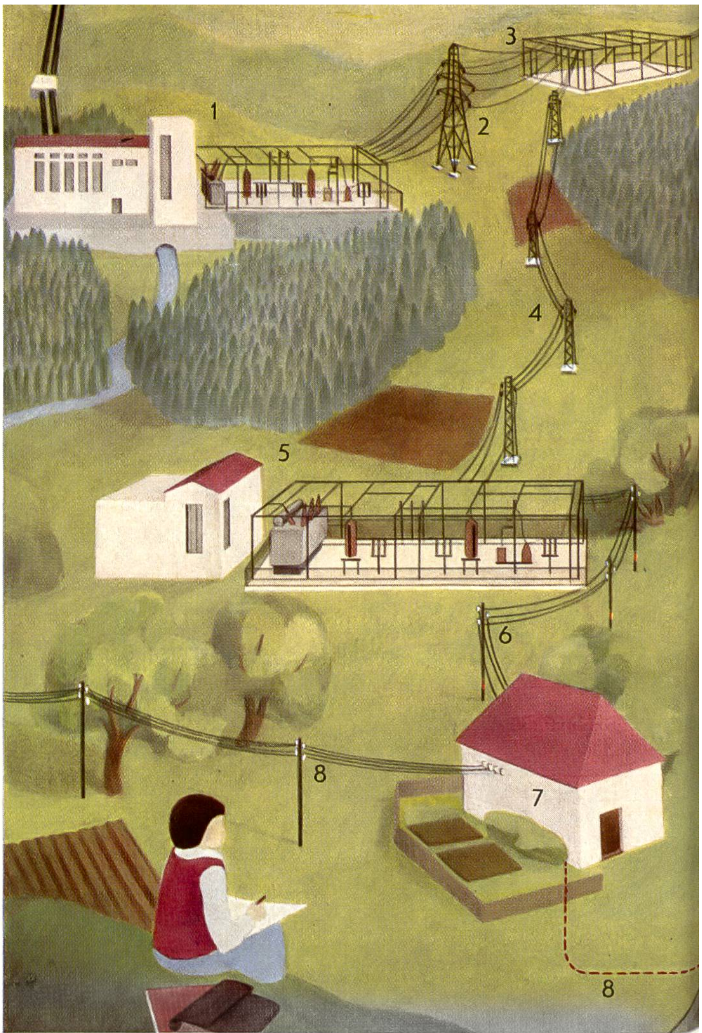
1: Hochdruck-Kraftwerk mit Freiluftanlage; 2: Höchstspannungsfernleitungen; 5: Unterwerk; 6: Hochspannungsleitung; 7: Transformator; 8: Niederspannungsleitung
