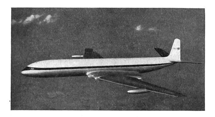
1956: Comet IV, 4motoriges Düsenverkehrsflugzeug für 60-76 Passagiere in Druckkabine. Spannweite 35 m. Fluggewicht 70000 kg. Reisegeschwindigkeit 800 km/h. Motorleistung 18144 kg Schub, entsprechend ca. 53000 PS bei 800 km/h. Reichweite 4800 km.
