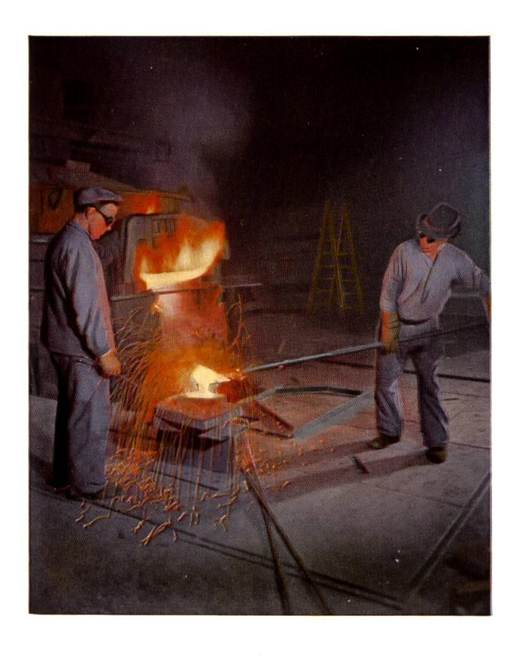
Entnahme einer Stahlprobe am Elektro-Ofen.
