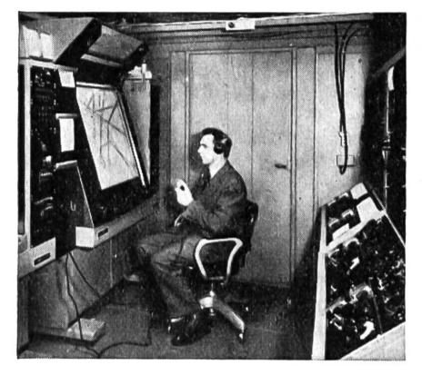
Ein Panthograph zeichnet die von den Pilotenschülern Flight-Simulator «geflogene» Route auf; sie wird von einem Instruktor überwacht. der mit den Piloten in Funkverbindung steht und wie der Beamte im Kontrollturm eines Flughafens die nötigen Start- und Landeanweisungen gibt. Dabei können die technischen Gegebenheiten jedes beliebigen Flughafens «simuliert» werden.
