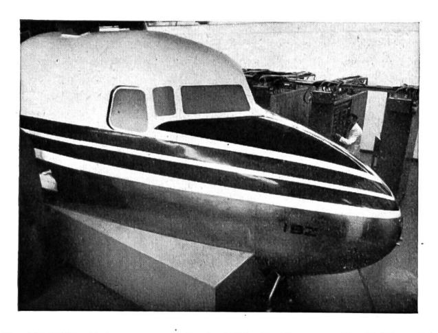
Der Flight Simulator von aussen. In der Bildmitte die genaue Nachbildung der Nase eines DC-6B, im Hintergrund die vier Elektronenkasten, von denen jeder einen Motor und seine Funktionen darstellt.
