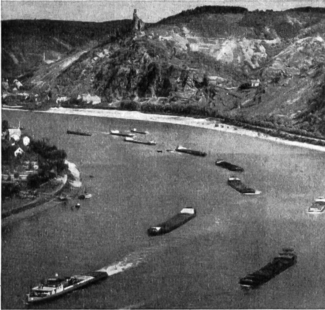
Der Dieselschlepper «Unterwalden» (Bildrand unten links) hat 7 Kähne mit je etwa 1500 Tonnen Ladung im Anhang, von denen jeder mit einer besonderen Schlepptrosse (Drahtseil) mit dem Schlepper verbunden ist. Die beiden Schiffe aussen rechts gehören nicht zum Schlepptzug.
