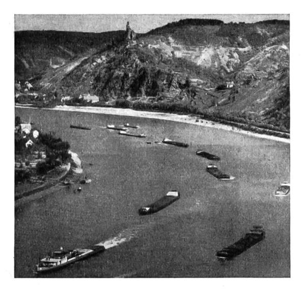
Der Dieselschlepper «Unterwalden» (Bildrand unten links) hat 7 Kähne mit je etwa 1500 Tonnen Ladung im Anhang, von denen jeder mit einer besonderen Schlepptrosse (Drahtseil) mit dem Schlepper verbunden ist. Die beiden Schiffe aussen rechts gehören nicht zum Schleppzug.
