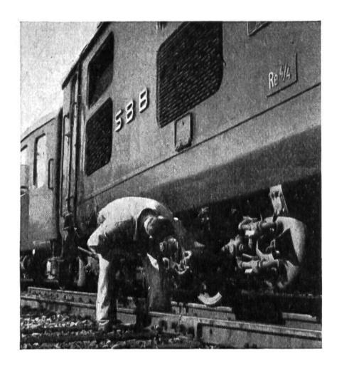
Bei kurzen Zwischenhalten steigt der Lokomotivführer oder sein Beimann aus dem Wagen. Mit prüfendem Blick und tastender Hand vergewissert er sich, dass alles in Ordnung ist.
