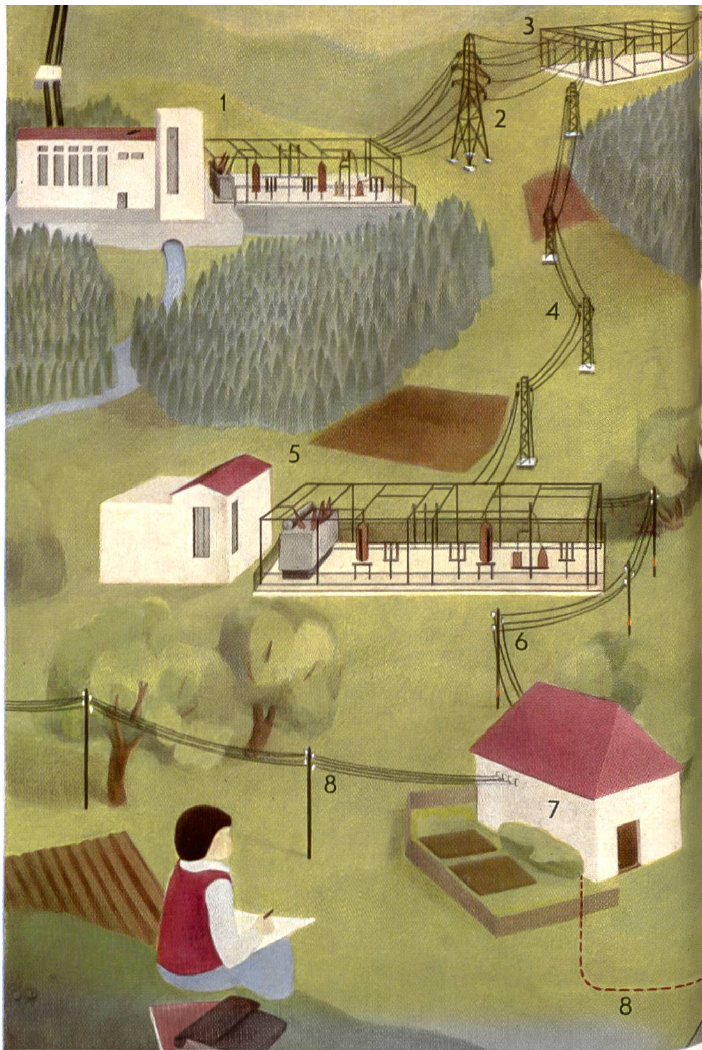
1: Hochdruck-Kraftwerk mit Freiluftanlage; 2: Höchstspannungsfernleitungen; 5: Unterwerk; 6: Hochspannungsleitung; 7: Trans
