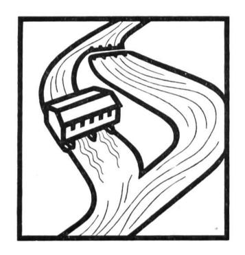
Als Niederdruck-Laufwerke bezeichnet man Wasserkraftwerke, die ohne besondere Stauseen in den Flusslauf gebaut werden und einen Teil des fliessenden Wassers ableiten und mit wenig Gefälle, aber grosser Wassermenge Elektrizität erzeugen. grössten Niederdruck-Laufwerke befinden sich im Mittelland, an der Aare, der Limmat, dem Rhein und der Rhone. Die Laufwerke übernehmen mit ihrer Leistung die Grundlast unseres Energiebedarfs.
