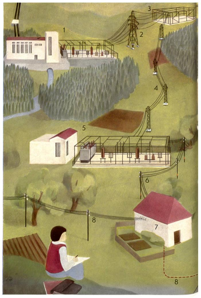
1: Hochdruck-Kraftwerk mit Freiluftanlage; 2: Höchstspannungsfernleit leitungen; 5: Unterwerk; 6: Hochspannungsleitung; 7: Trans
