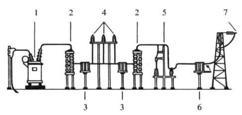
Aufbau einer Freiluftanlage. 1 Transformator. 2 Ölarme Schalter. 3 Trenner. 4 Sammelschiene dreiphasig. 5 Messwandler. 6 Trenner mit Erdmesser für die Erdung der Hochspannungsleitung. 7 Hochspannungsleitung.
