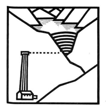
Hochdruck-Speicherwerkeerzeugen gleich wie Hochdruck-Laufwerke mit grossem Gefälle und kleiner Wassermenge grosse Energiemengen. Diese Speicherwerke verfügen über Stauseen, welche die grossen Wassermengen der Schneeund Gletscherschmelze und der Niederschläge im Frühling, Sommer und Herbst speichern. Im Winter ist nur geringer Zufluss. Sie decken Elektrizitätsverbrauch. welcher von den Laufwerken aufgebracht werden nicht
