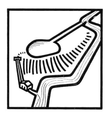
Hochdruck - Laufwerke oder ohne Tages-, oder Wochen- oder Monatsspeicher sind jene Wasserkraftwerke, bei denen das zufliessende Wasser laufend genutzt wird und der Überschuss über mehrere Stunden, einen oder mehrere Tage in einem Ausgleichsbecken aufgespeichert wird. Damit wird das Wasser in dieser Zeitspanne während geringerer Bean-Stunden spruchung bzw. Leistungsabgabe auf stärker belastete Stunden oder Tage, zum Bei-
