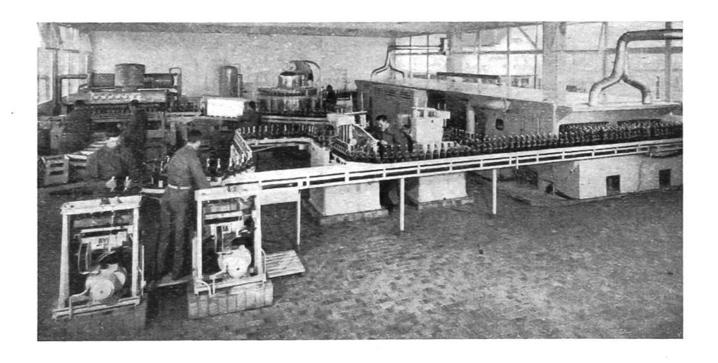
Vollautomatische Flaschen-Wasch- und -Abfüllanlage in einer Grossmosterei. Auf einem Fliessband gelangen die Flaschen zur Reinigung (hinten links), zur Abfüllung (hinten Mitte), weiter durch den langen Sterilisierapparat (rechts) und dann an der Etikettiermaschine (Mitte vorn) vorbei zur Kontrolle.
