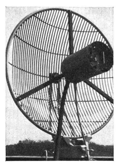
Ein frequenzmodulierter Richtstrahlsender. Der kleine 4-Watt-Sender ist zum Schutz gegen äussere Einflüsse vorne in einer Büchse untergebracht. Der aus Metallstäben zusammengesezte Parabolspiegel dient dazu, die vom Sender ausgehenden Wellen wie den Strahl eines Scheinwerfers zusammenzufassen.
