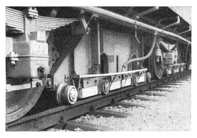
Die Riffelbildung kann maschinell durch den Schleifwagen behoben werden, dessen Leistungsfähigkeit ca. 2–3 km pro Tag beträgt.
