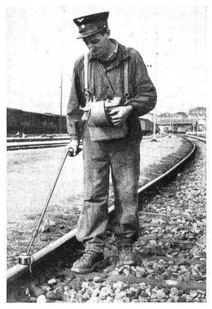
Mit dem Ultraschallgerät können unsichtbare Schäden im Geleise, wie z.B. Haarrisse und andere Bruchstellen in der Schiene, für Augeund Ohrwahrnehmbargemachtwerden.
