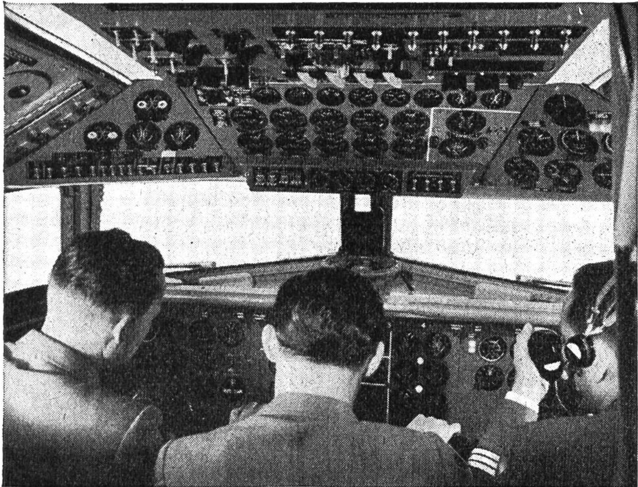
Im Cockpit eines Langstreckenflugzeuges sind stets drei Mann der Besatzung auf ihrem Posten. Links sitzt der Kommandant, etwas zurück in der Mitte der Bordmechaniker und rechts vorne der Flugkapitän. Die Führungskanzel eines DC-6B-Flugzeuges weist über 100 verschiedene Instrumente, Hebel und Schaltknöpfe auf.
