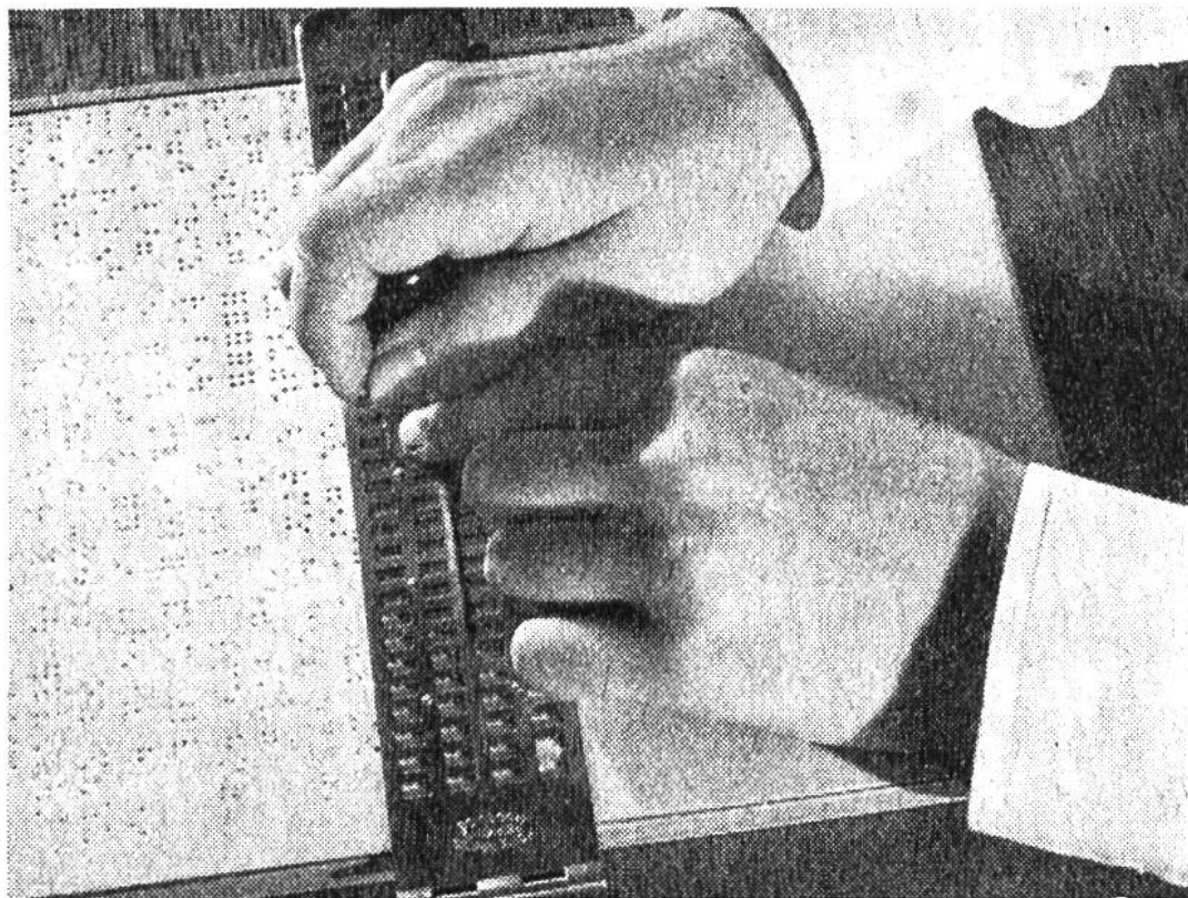
Ein Blinder schreibt für Blinde auf eine Blindenschrifttafel. Die Notizen werden auf der Rückseite gelesen, da dort die durch den Druck erzeugten Vertiefungen als Erhöhungen abgetastet werden können.
