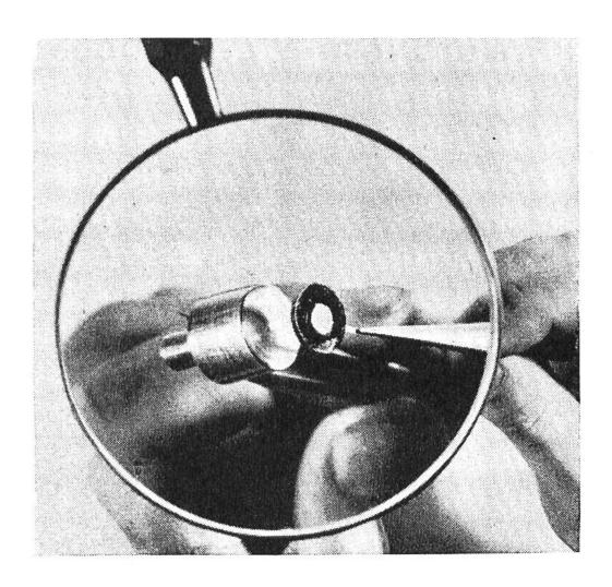
Die wichtigsten Bestandteile der Atombatterie unter dem Vergrösserungsglas. Der Zylinder (links) ist mit radioaktivem Strontium bedeckt. Wird er auf die Oberfläche des Halbleiters (rechts) gelegt, so werden die ausgestrahlten Elektronen vervielfacht und erzeugen eine elektrische Spannung, die man verwerten kann.
