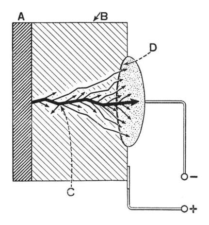
Schematische Darstellung der Atombatterie. Die von der Strahlungsquelle A ausgehenden Elektronen werden von einem Halbleiter B aufgefangen; dabei entstehen zahlreiche neue Elektronen C; diese sammeln sich auf der Platte D, wo sie eine hohe Spannung erzeugen.
