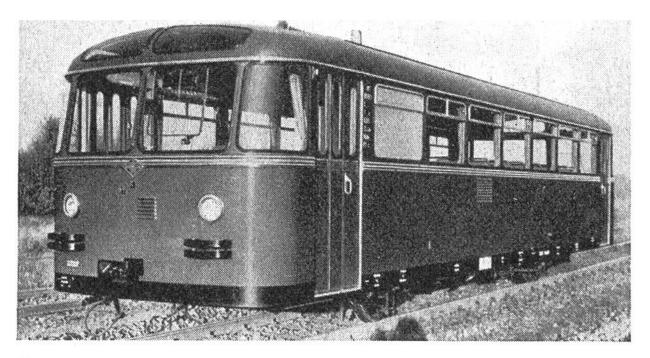
Deutscher Schienenomnibus für Strecken mit schwachem Personenverkehr. Dieselmotor, Leistung 130 PS, Höchstgeschwindigkeit 90 km/h, 63 Sitzplätze. Versuchsweise wurden kürzlich zwei solche Fahrzeuge auf den SBB-Strecken Oberglatt-Niederweningen und Etzwilen-Singen eingesetzt.
