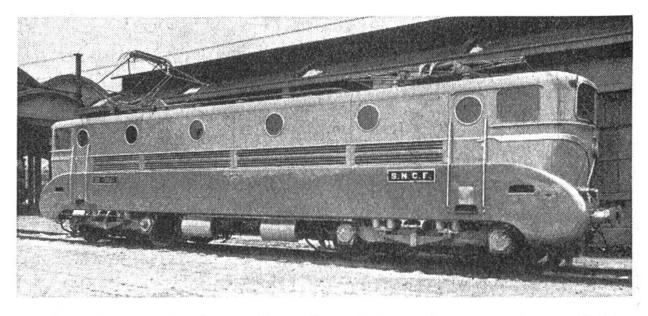
Laufachslose elektrische Schnellzugslokomotive der französischen Staatsbahnen. Leistung 4000 PS, Gewicht 80 t, Höchstgeschwindigkeit 160 km/h. Sie schleppt 750 t mit 140 km/h in der Ebene.
