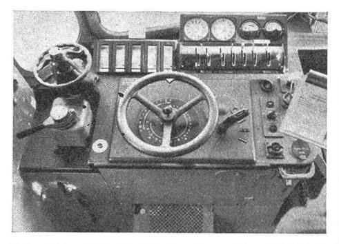
Der Führertisch der Lokomotive Ae 6/6. Links oben die Regulierbremse, darunter der Hebel für die automatische Bremse, rechts davon das Handrad für den Stufenschalter, rechts daneben der Wendeschalter für die
