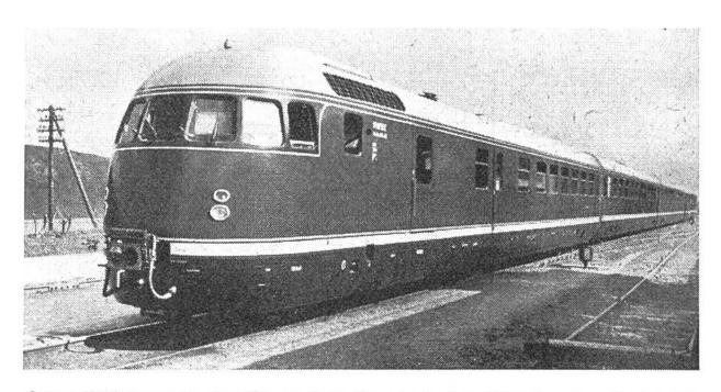
Schnelltriebwagen der Deutschen Bundesbahn. Dieselmotor, Leistung 1000 PS, Gewicht 146 t, Höchstgeschwindigkeit 120 km/h, 124 Sitzplätze. Ein solcher Triebwagen verkehrt täglich zwischen Frankfurt, Basel und Zürich als "Helvetia-Express" (Frkf.-Zch. 5 Std. 26 Min.).
