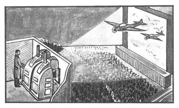
Für die Vorführung räumlich wirkender Filme mit polarisiertem Licht im Kino sind zwei Projektionsapparate und eine metallisierte Projektionswand erforderlich. Die Besucher müssen Polarisationsbrillen aufsetzen.
