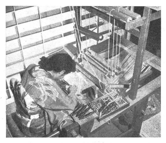
Japanerin am Webstuhl. Sichtbar sind die aufgespannte Kette und die Schäfte, vorn ein flaches Kistchen mit aufgespulten Seidenfäden und Weberschiffchen mit Spulen. Die Weberin hat mit der rechten Hand Teile der Kette gehoben und schiebt mit der linken ein Schiffchen ein.
