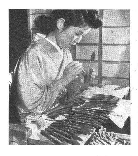
Die Weberin setzt eine Spule mit Seidenfaden im Schiffchen ein. Auf dem Brett weitere Schiffchen.
