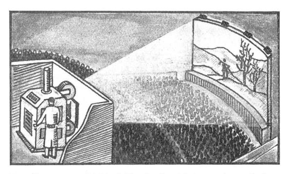
Das Cinemascope-Lichtspieltheater benötigt nur einen einzigen Projektionsapparat, der auf eine gewölbte Projektionswand ein Bild wirft, das 2½ mal länger ist als bei der normalen Kinovorführung.
