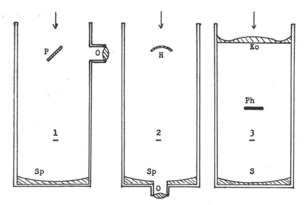
1. Newton-Teleskop. Das Bild wird vom Parabolspiegel Sp auf den ebenen Planspiegel P oder ein an gleicher Stelle befindliches Prisma geworfen und von dort zum Beobachtungs-Okular O reflektiert. Das Teleskop auf dem Mount Palomar wendet das gleiche Prinzip an.
