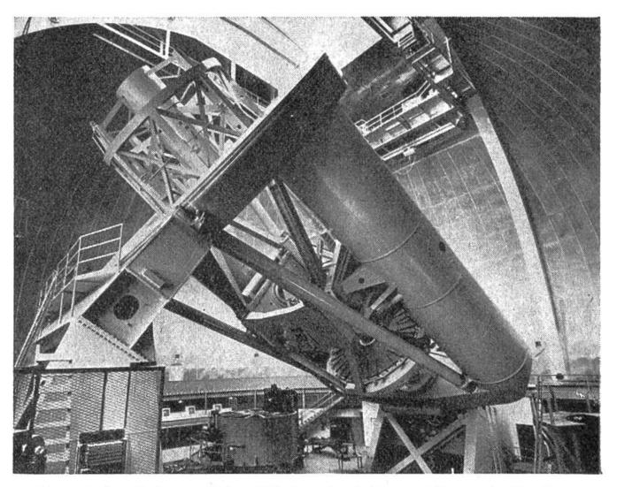
Das riesige Palomar-Spiegelteleskop besteht aus einer rohrförmigen Gitterkonstruktion, an deren unterem Ende der 5-m-Spiegel befestigt ist. Um ihn vor Staub und Beschädigung zu schützen, ist er ausser Gebrauch mit einer Irisblende bedeckt. Das Rohr ruht in einem mächtigen, hufeisenförmigen Lager von 15 m Durchmesser. Der Kessel im Hintergrund auf dem Boden der Sternwarte dient zum Aufdampfen von Aluminium auf die Oberfläche des Glasspiegels.
