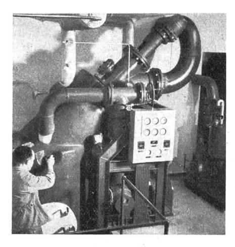
Das Bild zeigt uns den Kondensor, einen grossen, auf etwa -70°C gekühlten Kessel, in welchem das beim Eintrocknen dem Plasma entzogene Wasser in Form von Schnee gesammelt wird.
