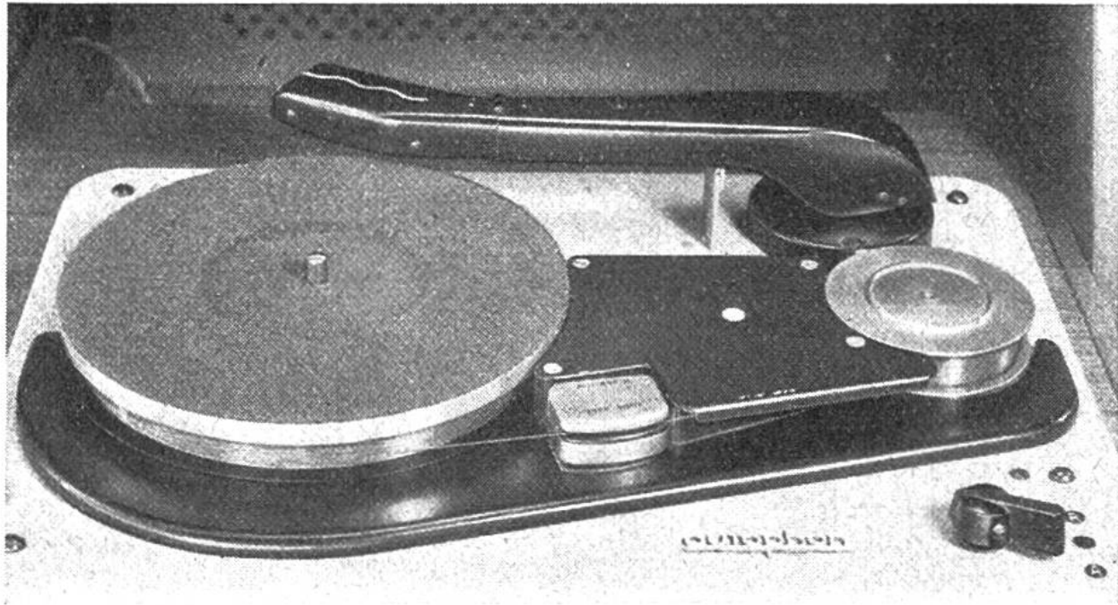
Ein schweizerisches Magnetongerät, Recordophon, zur Tonaufnahme mit Stahldraht. Der Apparat kann ausserdem zur Wiedergabe von Schallplatten dienen.
