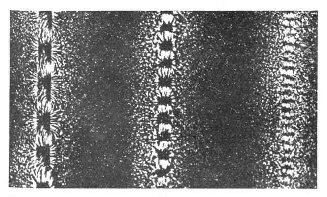
Magnetische Schallspuren von verschiedener Tonhöhe. Die Schallschwingungen rufen eine wechselnde Magnetisierung des Bandes hervor. Magnettonaufnahmen sind unsichtbar; mit Eisenpulver lässt sich jedoch die Magnetisierung sichtbar machen. (Aufnahme Dr. Lüthy.)
