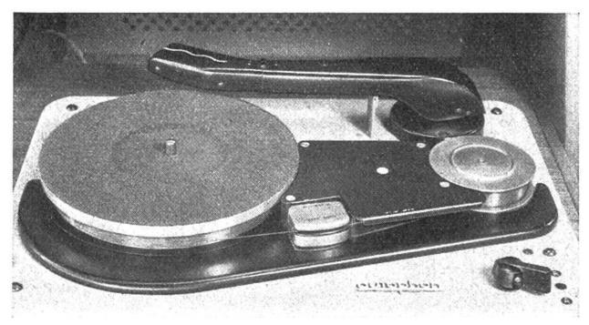
Ein schweizerisches Magnettongerät, Recordophon, zur Tonaufnahme mit Stahldraht. Der Apparat kann ausserdem zur Wiedergabe von Schallplatten dienen.
