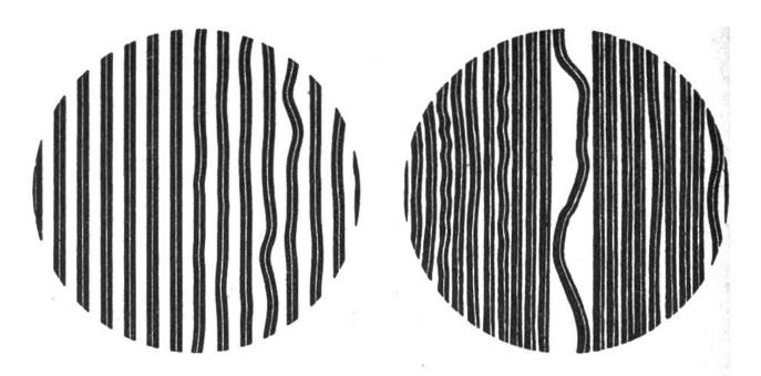
Der gleichmässige Rillenabstand der üblichen Schallplatten wird nur bei den selten vorkommenden grossen Lautstärken voll ausgenützt. Bei mittlerer und geringer Lautstärke wird daher Plattenraum verschwendet. (Links: 7 Rillen ohne Musik.)
