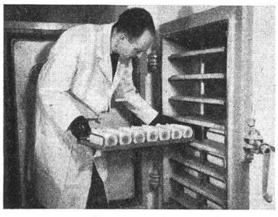
Die Flaschen mit dem gefrorenen Plasma werden zur Trocknung in eine Hochvakuumkammer gebracht.
