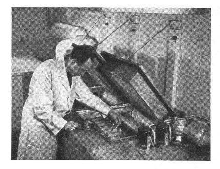
In diesem Apparat wird das Plasma zum Gefrieren gebracht. Die Flaschen liegen auf Metallrollen und drehen sich langsam um die eigene Achse. Gleichzeitig tauchen sie teilweise in eine Flüssigkeit ein, die auf -60° C abgekühlt ist.
