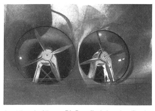
Die Propeller eines grossen Windkanals, in dem ganze Flugzeuge unterge-
