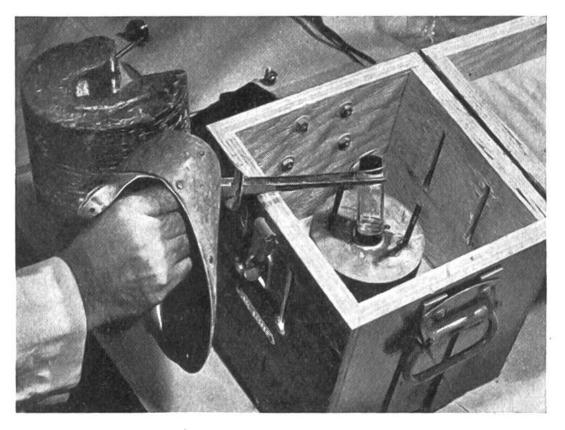
Nur 35 Tropfen der kostbaren radioaktiven Lösung einer Jodverbindung enthält die kleine Flasche, die mit einer langen Pinzette vorsichtig dem stählernen Transportbehälter entnommen wird. Die Hand muss mit einem Bleischild vor der durchdringenden Strahlung geschützt werden.
