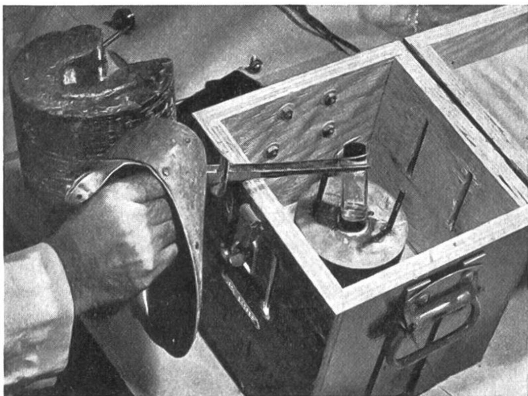
Nur 35 Tropfen der kostbaren radioaktiven Lösung einer Jodverbindung enthält die kleine Flasche, die mit einer langen Pinzette vorsichtig dem stählernen Transportbehälter entnommen wird. Die Hand muss mit einem Bleischild vor der durchdringenden Strahlung geschützt werden.
