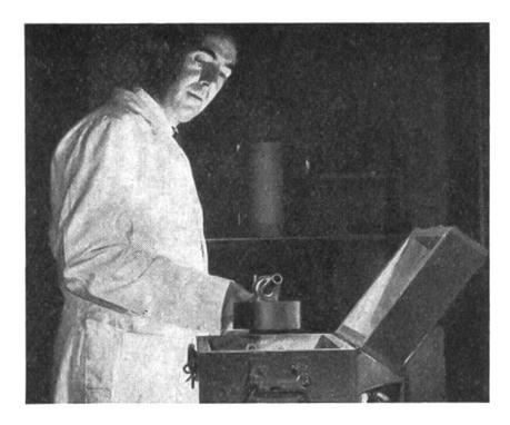
Eine Sendung aus der Atomstadt Oak Ridge (USA) ist angekommen. Mit grosser Sorgfalt wird der stählerne Dekkel von dem Stahlzylinder entfernt, in dessen Bohrung ein kleines Fläschchen mit der lebensgefährlich strahlenden Substanz ruht.
