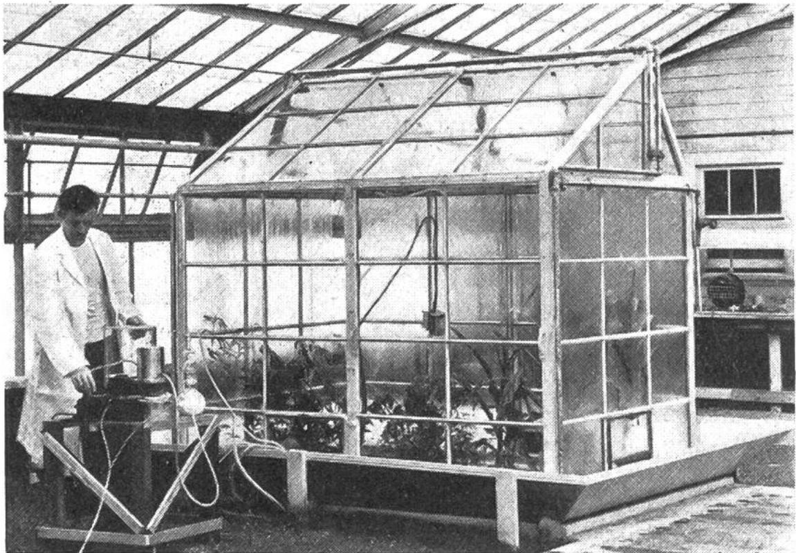
In diesem hermetisch verschlossenen kleinen Glashaus werden Pflanzen in einer Atmosphäre aufgezogen, die radioaktives Kohlendioxid enthält. Die Pflanzen nehmen dabei radioaktiven Kohlenstoff auf und lassen sich deshalb zu Heilmitteln verarbeiten, die selbst strahlen und deshalb bei der Erforschung ihrer Wirkung im menschlichen Körper als „Spurfinder“ dienen.
