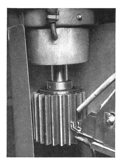
Diese Vorrichtung dient zum Härten von Zahn-rädern. Die Induktionsspule ist so geformt, dass sie einen kleinen Teil eines einzelnen Zahnes umfasst. Um den Zahn der ganzen Länge nach zu härten, wird das Zahnrad in der Achsenrichtung bewegt.
