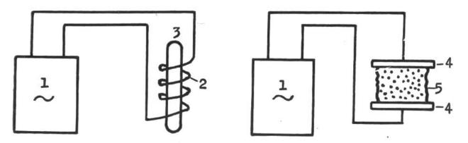
Prinzip der Hoch frequenzheizung. Links: Heizung für elektrisch-leitende Stoffe (Metalle). Rechts: Heizung für schlecht- oder nichtleitende Stoffe. 1) Stromquelle für hochfrequenten Wechselstrom. 2) Induktionsspule. 3) Metallgegenstand, der erhitzt wird. 4) Metallplatten. 5) Gegenstand aus schlecht- oder nichtleitendem Material, der erhitzt wird.
