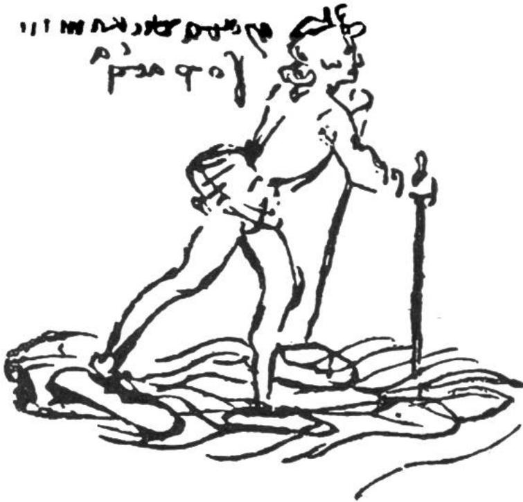
„Art, über das Wasser zu gehen.“ Der von Leonardo skizzierte Wasserläufer trägt unter den Füßen und unter den Stöcken Tragkörper – entweder luftgefüllte Tierblasen oder Korkplatten.
