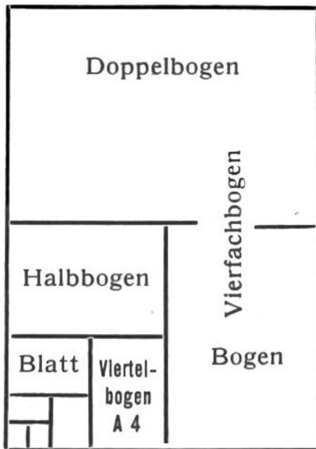
Das Verhältnis von Breite zu Höhe ist immer dasselbe, nämlich  $1:\sqrt{2}$ , das bedeutet: Breite = Seite eines Quadrates, Höhe = dessen Diagonale. A0 misst  $1\text{ m}^2$ . A1, A2 usw. ergeben sich durch fortgesetztes Halbieren.
