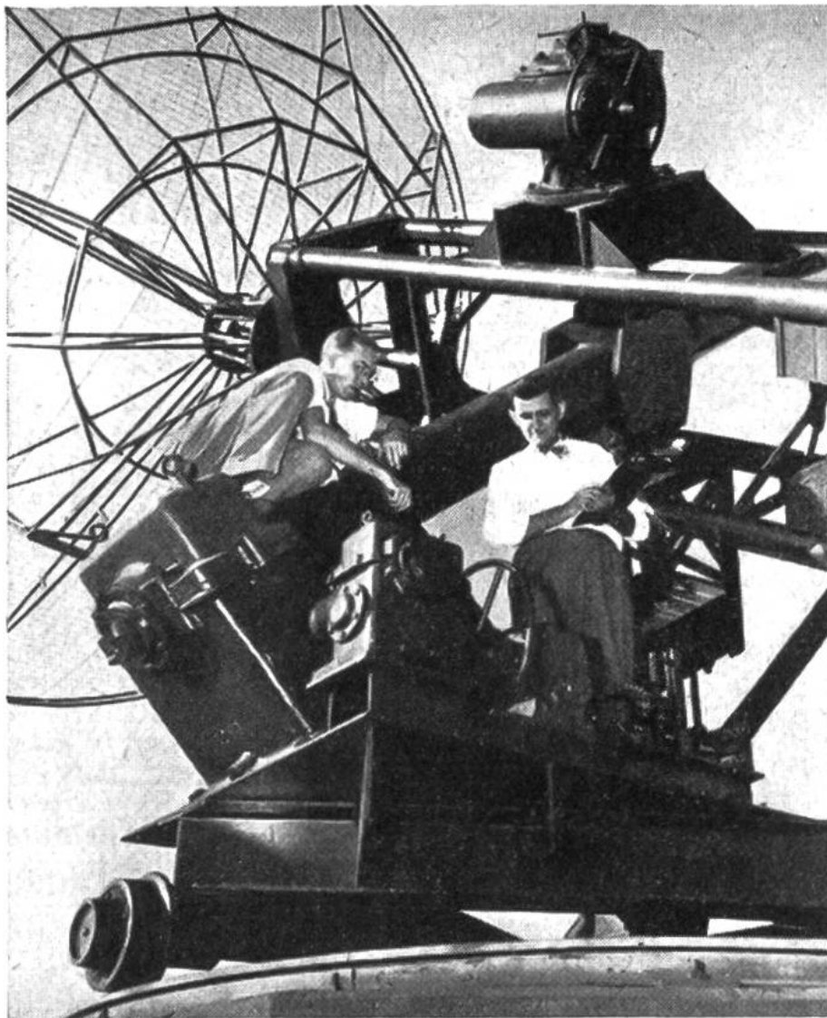
Das Radioteleskop der Cornell-Universität in Amerika. Die Empfangsantenne liegt im Brennpunkt ei-
