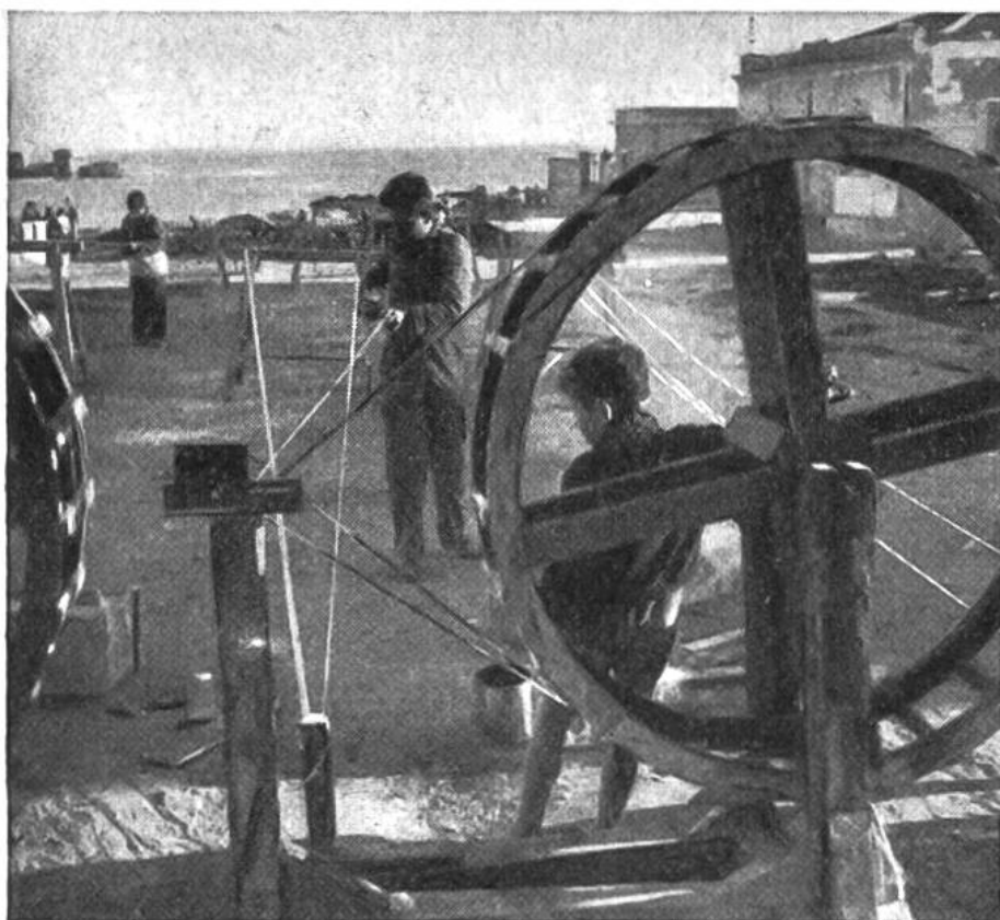
Die unglaublich langen Seile zum Knüpfen der Fischernetze werden von der Jungmannschaft im Freien an hohen Holzrädern „gesponnen“.
