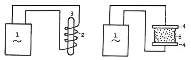
Prinzip der Hoch frequenzheizung. Links: Heizung für elektrisch-leitende Stoffe (Metalle). Rechts: Heizung für schlecht- oder nichtleitende Stoffe. 1) Stromquelle für hochfrequenten Wechselstrom. 2) Induktionsspule. 3) Metallgegenstand, der erhitzt wird. 4) Metallplatten. 5) Gegenstand aus schlecht- oder nichtleitendem Material, der erhitzt wird.
