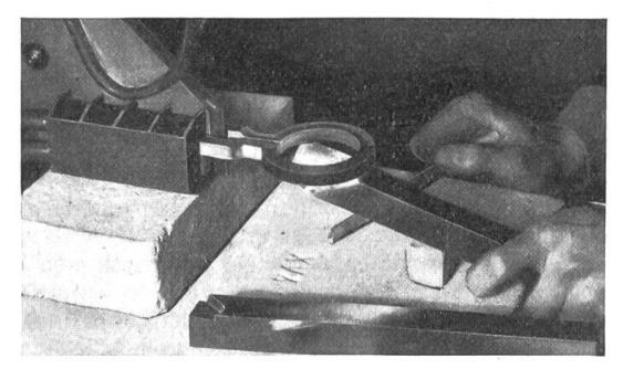
Mit diesem Apparat werden Hartmetallschneiden auf Drehstähle aufgelötet. Der Hochfrequenzstrom wird durch die ringförmige Spule geleitet. Wenn man den Drehstahl von unten her in die Spule einschiebt, wird seine Spitze glühend. Die Lötzeit beansprucht nur 15–20 Sekunden, wodurch das kostspielige Hartmetall sehr geschont wird.
