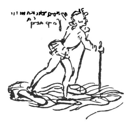
"Art, über das Wasser zu gehen." Der von Leonardo skizzierte Wasserläufer trägt unter den Füssen und unter den Stöcken Tragkörper – entweder luftgefüllte Tierblasen oder Korkplatten.
