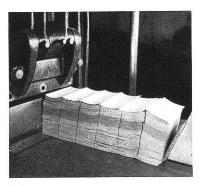
Diese Maschine verarbeitet sämtliche Holzarten. Immerhin sind astfreie, elastische Hölzer mit wenig Feuchtigkeitsgehalt zur Zündholz-Herstellung bevorzugt. Linde, Pappel und Weymouth-Föhre werden am häufigsten verwendet.
