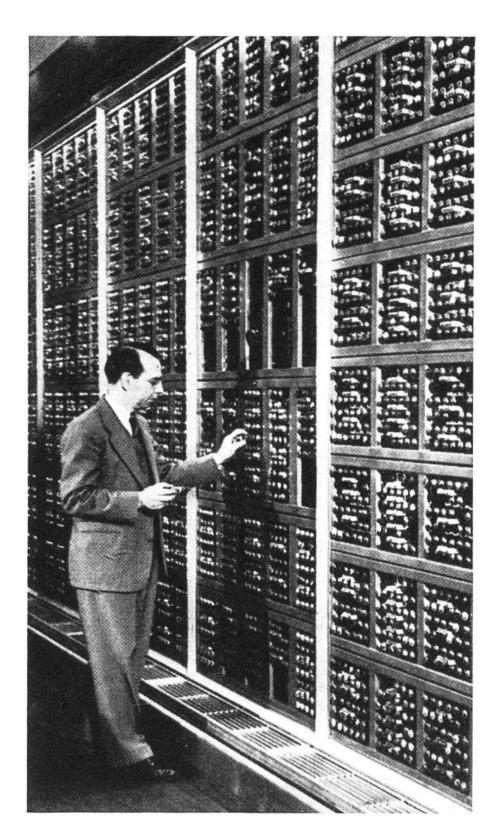
Die elektronische Rechenmaschine enthält 12 500 Elektronenröhren und 24 000 Relais. Hier wird eine Röhre ausgewechselt.
