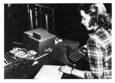
Das Rechenprogramm wird auf perforierten Karten festgelegt und dann der Maschine zur Verarbeitung übergeben.
