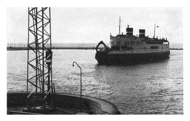
Ein Fähreschiff nähert sich der Anlegestelle; der Bug ist bereits aufgeklappt.
