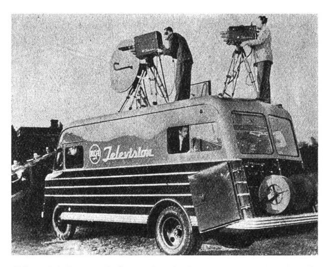
Abb. 5. Bei Aussenaufnahmen wird ein Fernsehwagen benützt, der mit Aufnahmekameras und einem Mikrowellensender ausgestattet ist.
