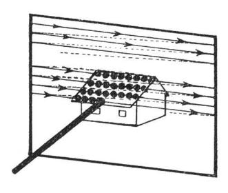
Abb. 2. Beim Fernsehen werden die Bilder in engen Zeilen abgetastet und dabei in einzelne Punkte zerlegt, deren Helligkeitswerte als elektrische Impulse übertragen werden. Indem man der Reihe nach die ungeradzahligen und dann die geradzahligen Zeilen abtastet, wird das Flimmern des Bildes verringert.
