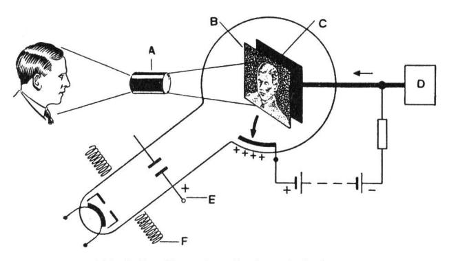
Abb. 1. Das Ikonoskop dient zur Aufnahme von Fernsehbildern (Erklärung im Text).
