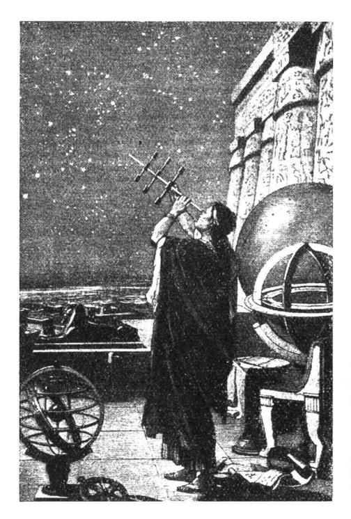
Ein Alexandriner misst die Höhe eines Sterns mit Hilfe des Jakobsstabes. Dieses Winkelmess-Instrument diente früher den Seefahrern zur Bestimmung der Zeit und geographischen Breite.
