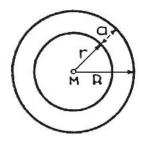
R = äusserer Radius. r = innerer Radius. a = radiale Breite des Kreisrings. M = Mittelpunkt.
