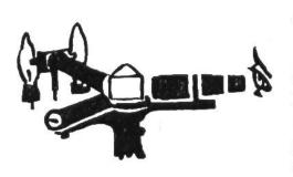
1859 erkannten die deutschen Physiker Bunsen und Kirchhoff, dass durch die Zerlegung der Lichtstrahlen eines brennenden Körpers mit Hilfe eines Prismas die Beschaffenheit dieses Körpers nachzuweisenist. Das entstehende Bild (Spektrum) weist schwarze Linien auf, die für jeden Körper an versch. Stellen auftreten.
