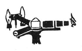
1859 erkannten die deutschen Physiker Bunsen und Kirchhoff, dass durch die Zerlegung der Lichtstrahlen eines brennenden Körpers mit Hilfe eines Prismas die Beschaffenheit dieses Körpers nachzuweisenist. Das entstehende Bild (Spektrum) weist schwarze Linien auf, die für jeden Körper an versch. Stellen auftreten.
