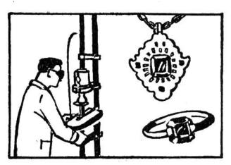
steine Korund und Spinell herstellen lassen. Das Verfahren ist inzwischen so weit verbessert worden, dass sämtliche Edelsteine mit Ausnahme des Diamanten künstlich erzeugt werden können. Die dem Edelstein entsprechende Masse wird in
