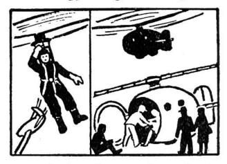
2 Flügeln (Rotor), die sich über dem Kopf des aus einem Flugzeug Abspringenden sehr rasch drehen. Die Fallgeschwindigkeit soll bedeutend geringer sein als beim Fallschirm aus Stoff, wodurch eine ungefährlichere Landung ermöglicht wird,
