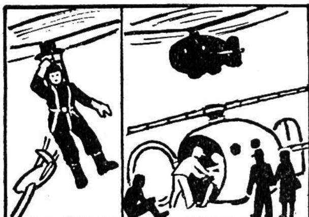
2 Flügeln (Rotor), die sich über dem Kopf des aus einem Flugzeug Abspringenden sehr rasch drehen. Die Fallgeschwindigkeit soll bedeutend geringer sein als beim Fallschirm aus Stoff, wodurch eine ungefährlichere Landung ermöglicht wird,
