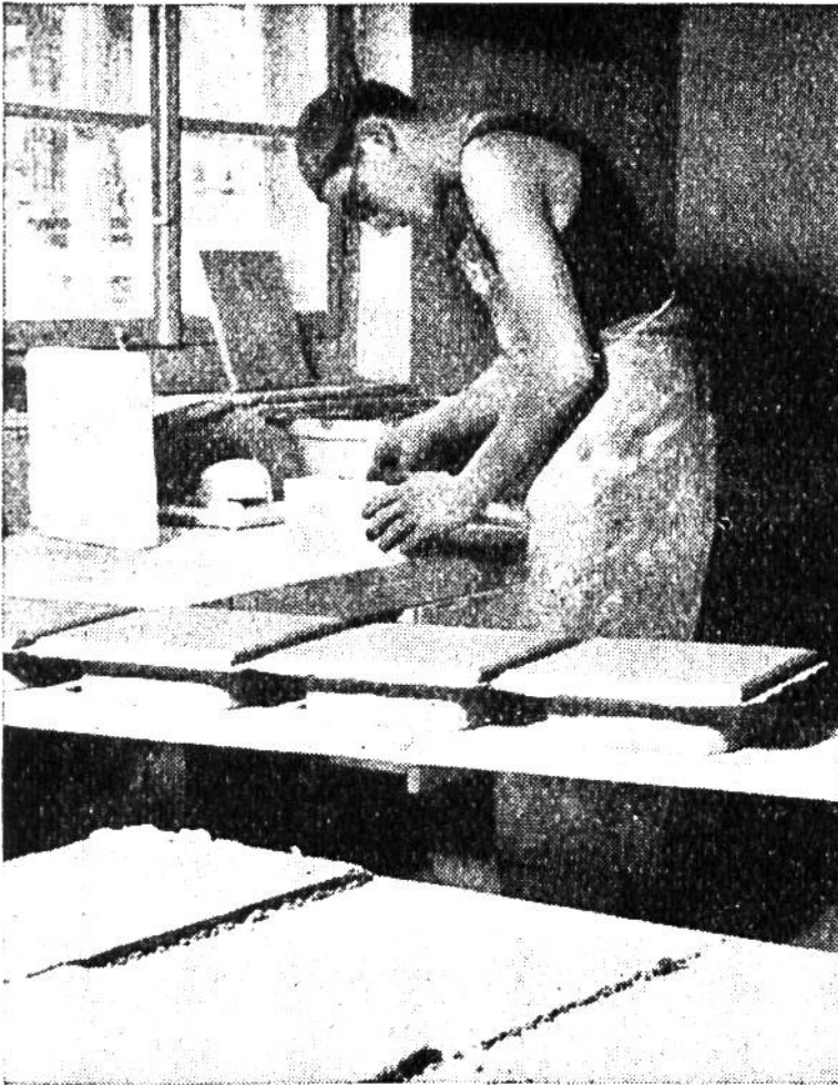
Der Lehm wird in „Blättern“ abgeschnitten und dann in Gipsformen gelegt.
