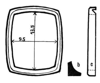
Planskizze zum Bilderrahmen, der sich für Hochund Querformat eignet. a = Aufsicht (Masse in cm). b = Querschnitt des Rahmens. c = Seitenansicht.
